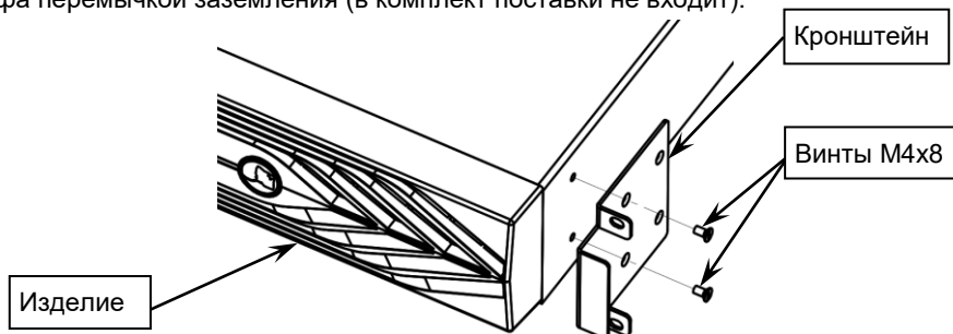
Рисунок 4 — Установка кронштейнов на корпус изделия.
